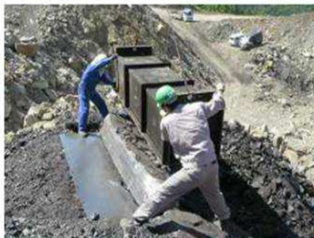
写真 2-4 切出した石炭に鋼製容器を被せる
