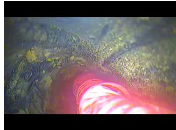
現場UCG実験における石炭のレーザー着火 第一回目実験（平成28年度）
